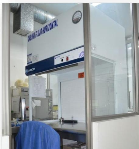
**Filtro Hepa y Medidor de Presión:** Área filtrada al 99,99% de eficiencia, medidor de presión para evaluar el nivel de saturación del filtro hepa.
