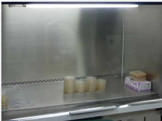
**Filtro HEPA y medidor de presión:** Área de trabajo con filtración al 99,99% de eficiencia. se cuenta con dos filtros hepa (área de trabajo y exhaustado) medidor de presión para evaluar el nivel de saturación del filtro hepa del área de trabajo.
